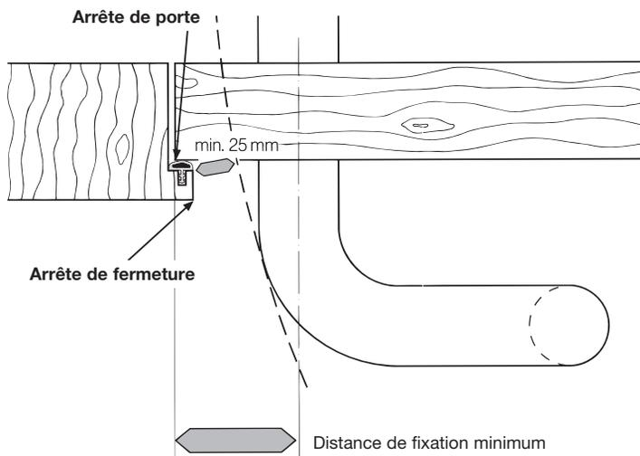
**Distance de sécurité par rapport au recouvrement suivant DGUV (Deutsche Gesetzliche Unfallversicherung)**
