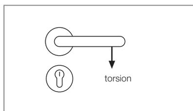
mini, techniques R et H de la classe 4 « Sécurité » satisfont à la charge supplémentaire de  $F=2500\text{ N}$ . Le test « Sécurité » ne doit pas être confondu avec le terme « Garnitures de Sécurité ».
