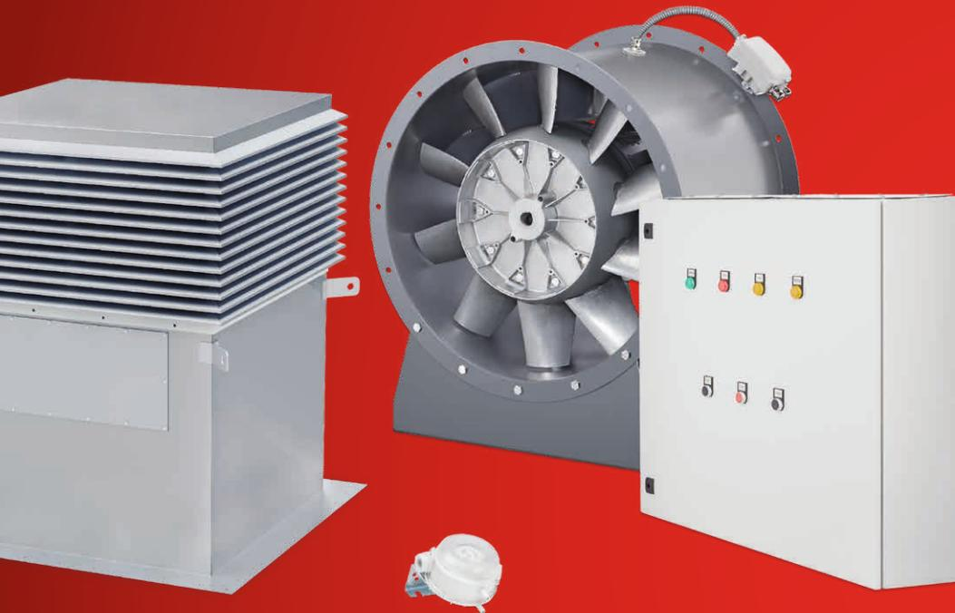
Treppenhaus-Spüllüftungsanlagen mit geregelter Druckhaltung realisieren eine Verdünnung und Ausspülung der Brandgase. Zusätzlich wird durch den Aufbau eines geregelten Differenzdrucks ein weiterer Raucheintrag in den Rettungsweg verhindert.
