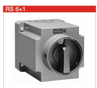
Spannung 400 V, 3~, 50/60 Hz. Schutzart IP 65. Schutzklasse II. Betätigung Drehantrieb. Verriegelungsmögl. „0 OFF“ und „I ON“. Temperaturbereich -25 bis +60 °C. Gehäuse UV- und Witterungsbeständig. Schaltplan-Nr. 1088.
