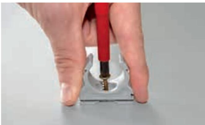
Die Verwendung großer Schrauben oder Halbrund-Schrauben verhindert das Durchschrauben des clipfix-Sockels während des Befestigens sowie das Durchziehen des Schraubenkopfes durch den clipfix-Sockel nach der Montage.
