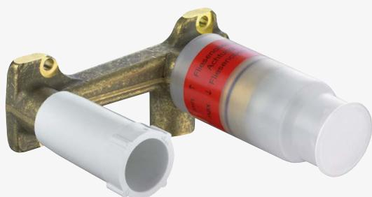
Durchflussmenge 16l/min. bei 3 bar, Keramik-Kartusche mit Heißwasserbegrenzung, Anschluss ½", mit Rohbaustopfen G 1/2, Montagetiefenausgleich 30 mm, Geräuschklasse I
