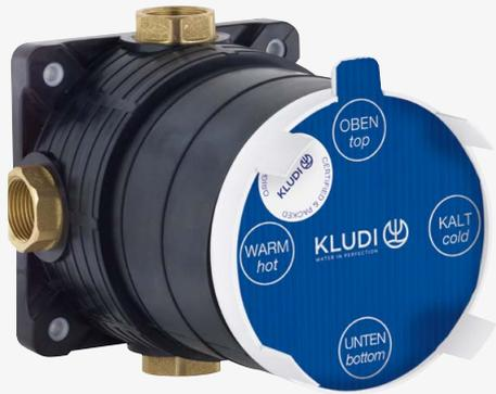
Unterputz-Rohbau-Set für Wandeinbau, einteiliger Elastomere-Mantel, mit Rohbau Schutzkappe, mit Prüf- und Spülblock, ohne Funktionseinheit, mit zusätzlicher Dichtmanschette, Abdichtung nach DIN 18534
