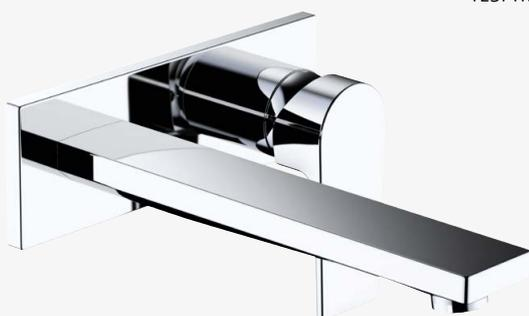
verchromt, vertikale Wandmontage, geschlossener Hebel Metall, Strahlregler M24, Durchflussmenge bei 3 bar = 7 l/min., fester Auslauf 230 mm, Ausladung 230 mm
