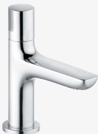
verchromt, Ausladung 100 mm, Auslaufhöhe 80 mm, Keramik-Oberteil 90°, Caché Eco s-pointer Strahlregler M 18,5, Durchflussmenge 7,6 l/min bei 3 bar, mit Schaftbefestigung G ½, ohne Kupferrohr mit Bördelung Ø 10 mm x 500 mm, ohne Armaturenanschlussdruckschlauch G 1/2 x G 3/8 x 500 mm
