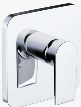
Feinbau-Set mit Funktionseinheit, verchromt, geschlossener Hebel Metall, Keramik-Kartusche mit Heißwasserbegrenzung, Durchflussmenge bei 3 bar 25 l/min., ohne Unterputz-Rohbau-Set (TEEIKFTM)
