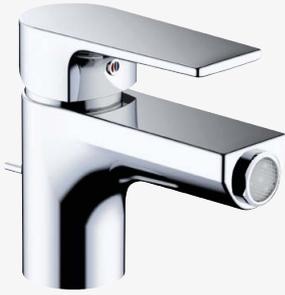
verchromt, Ausladung 110 mm, DN 15/PN 10, S-Pointer M24 PCA, Keramik-Kartusche mit Heißwasserbegrenzung, Durchflussmenge bei 3 bar = 6 l/min., flexible Druckschläuche G 3/8, mit Ablaufgarnitur 1¼", Schnell-Montagesystem, Geräuschprüfzeichen beantragt
