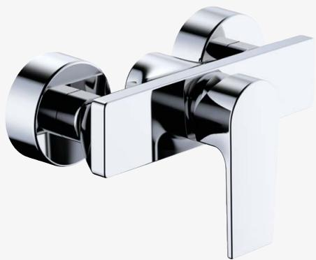
verchromt, Keramik-Kartusche, eigensicher gegen Rückfließen nach DIN EN 1717, S-Anschlüsse G 1/2 x G 3/4, Anschluss 1/2", Ausladung 110 mm, Geräuschprüfzeichen beantragt
