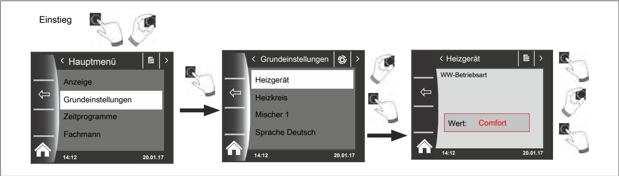
Abb. 9.1 Beispiel Warmwasser Betriebsart
