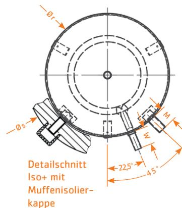
Fertigungstoleranzen nach DIN ISO 13920 C
