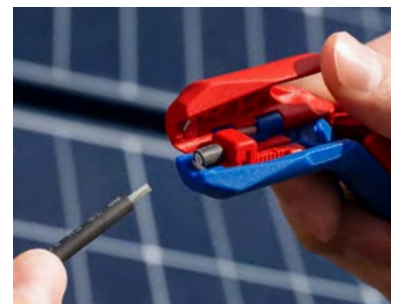
16 95 03 SB: Längenanschlag für PV-Kabel: Einstellbar von 6 – 18 mm für reproduzierbare Abisolierlängen, passend für alle gängigen PV-Verbinder
