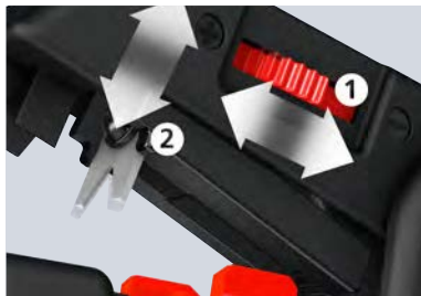
Feinjustierung ermöglicht die genaue Einstellung der Einschnitttiefe auf spezielle Materialien oder Temperaturbedingungen
