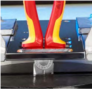
Prüfung der Haftfähigkeit der VDE-Hüllen mit 500 N bei 70°C.
