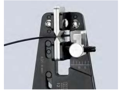
Sauberes Einschneiden der Isolation auf dem gesamten Umfang
