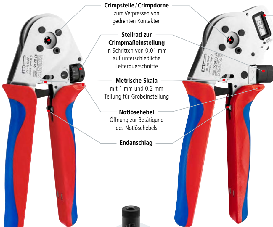
97 52 65 Kapazität 0,14 – 6 mm 2 max. Kontaktdurchmesser 7,5 mm
