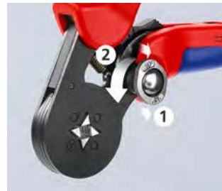
Die Crimpzange kann mit dem Stellrad auf große Aderendhülsen von ① 16 mm 2 oder ② 2 x 10 mm 2 eingestellt werden
