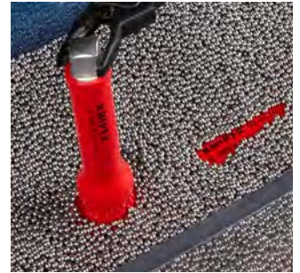
Prüfung der elektrischen Isoliereigenschaften.
