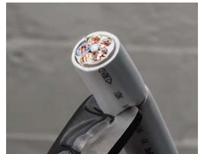
Abgestufte Schneiden und Haltehorn verhindern das Herausrutschen von kleineren und größeren Kabeln
