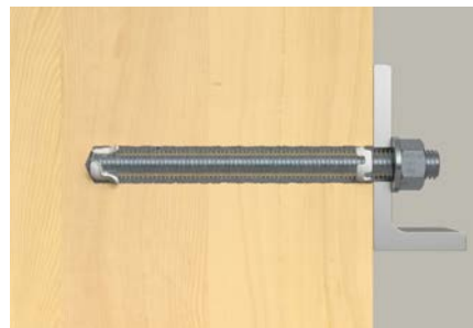
Injektionsmörtel FIS EM Plus in Holz mit Ankerstange FIS A
