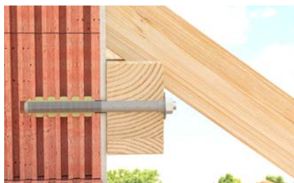
Verankerung von Holzanbauteilen
