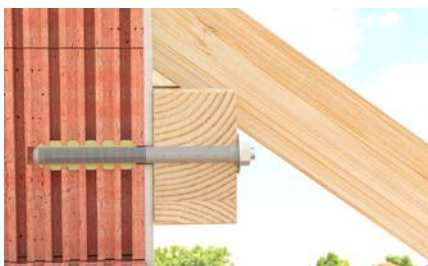
Verankerung von Holzanbauteilen
