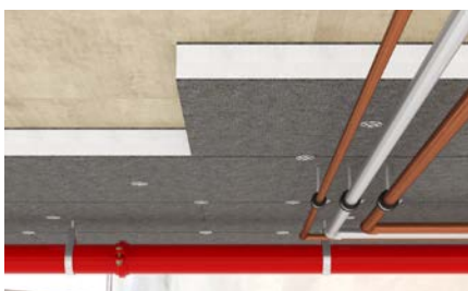
Befestigung von Dämmplatten
