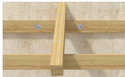
Pfetten / Streichbalken an Wand
