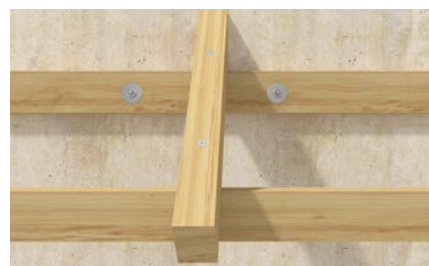
Verankerungen von Pfetten und Streichbalken
