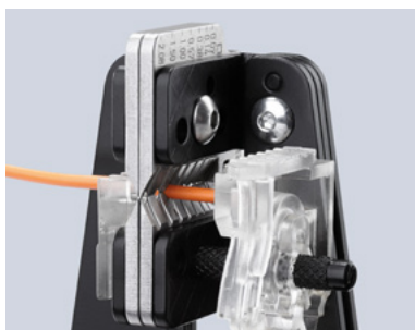
Sauberer Einschnitt der Isolation auf dem gesamten Umfang
