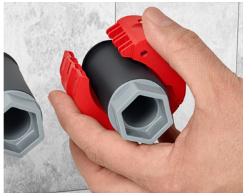
Durch die einzigartige Konstruktion des drehbaren Messerblocks lassen sich Tropf- und Dichthülsen zuverlässig 2 bis 3 mm vor der Wand einkürzen, um Feuchtigkeit sicher abzuleiten
