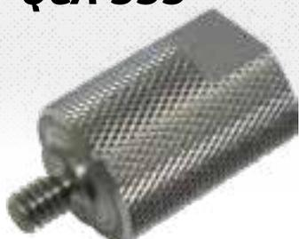
**Ventajas:** Adaptador Quick Change Disc con rosca hembra M14 y rosca macho 1/4"-20 - Permite el uso de Klingspor Quick Change Discs en todas las amoladoras angulares corrientes en el mercado
