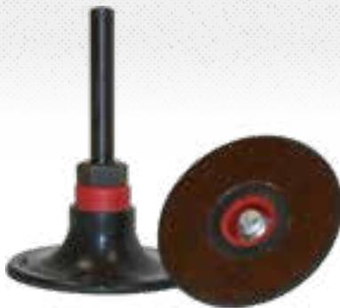
**Ventajas:** Montaje seguro de los discos QMC - Propiedades abrasivas optimizadas (agresividad, calidad de superficie) gracias a los tres grados de dureza - Diferenciación sencilla de las durezas mediante anillos de color - Tuerca de sujeción desenroscable, permitiendo el uso en una amoladora angular o con el adaptador QCA 555 mediante una rosca de 1/4"-20
