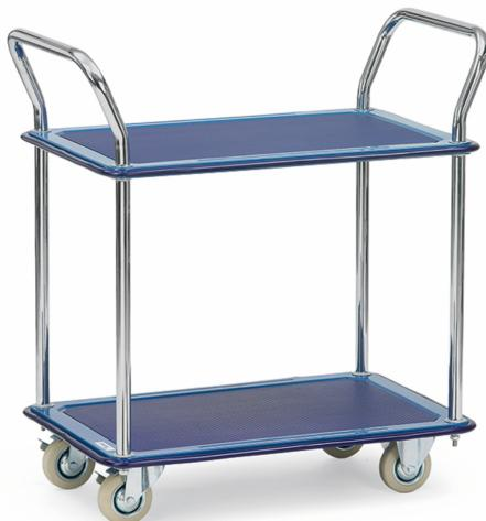
Tischwagen mit 2 Plattformen aus Stahlblech gepresst, pulverbeschichtet brilliantblau RAL 5007. Mit aufgeklebtem Antirutschbelag und umlaufender Schutzleiste. Rohrschiebebügel feststehend, glanzverzinkt. 2 Lenk- und 2 Bockrollen, Vollgummi-Bereifung, Feststeller an den Lenkketten, gemäß der Europäischen Norm EN 1757-3. Zerlegte Anlieferung. Tragkraft obere Ladefläche 60 kg.
