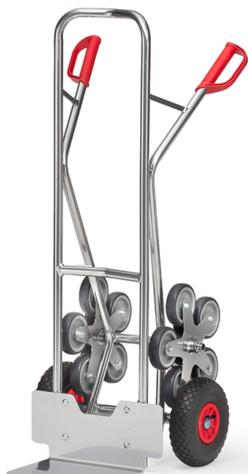
Aus Aluminiumrohr mit Aluminiumschaufel, handliche Schweißkonstruktion. Sicherheitsgriffe. Mit 2 Lufträdern, Kunststoff-Felgen, Nabensicherung und 2 fünfarmigen Radsternen, jeweils 5 TPE-Räder 125 mm Ø, Nabensicherung. Bügel oben und Querstreben durchgebogen. Für den sicheren Transport von runden Gütern, wie Rollen, Kannen, Eimern usw.
