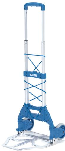
Paketroller - erstklassig verarbeitete Aluminium-Stahlrohrkonstruktion mit Aluminium-Schaufel und hochwertigen Kunststoffteilen. Räder mit Polymerbereifung blaugrau spurlos, Nabens mit Rollenlager. Griffbügel aus handsympathischem rutschsicherem Material. Elastisches Spannband und Spanngleiste zur Sicherung des Transportgutes. Schaufel und Räder mit einem Handgriff an- und abklappbar, Griffholm einschiebbar. In wenigen Sekunden einsatzbereit.
