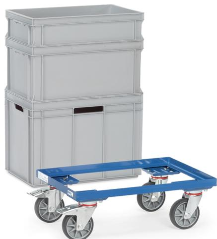
Eurokasten-Roller in offener Winkelstahlkonstruktion, pulverbeschichtet blau RAL 5007. 4 Lenkkästen mit TPE-Bereifung, Nabensicherung mit Rillenkugellager. 2 Stück mit Feststeller, gemäß der Europäischen Norm EN 1757-3 (Sicherheit von Plattformwagen). Passend für Eurokästen 600 x 400 mm.
