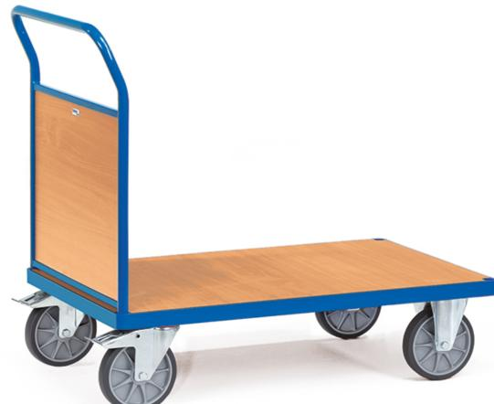
Stahlrohr und Profilstahl geschweißt, pulverbeschichtet RAL 5007, Plattform Holzwerkstoffplatte, Oberfläche Buchendekor. Stirnwand aus Holzwerkstoffplatte, Oberfläche Buchendekor, Wand 500 mm hoch. 2 Lenk- und 2 Bockrollen, TPE-Bereifung, Nabensicherung mit Rillenkugellager. Feststeller an den Lenkrollen, gemäß der Europäischen Norm EN 1757-3 (Sicherheit von Plattformwagen).
