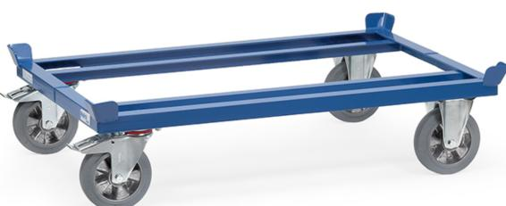
Für Flachpaletten und Gitterboxen. Robuste Winkelstahl-Schweißkonstruktion, mit 4 Fangecken, pulverbeschichtet, blau RAL 5007. 2 Lenk- und 2 Bockrollen, Elastic-Vollgummi-Bereifung, Nabensicherung, blaugrau "spurlos", Feststeller an den Lenkketten, gemäß der europäischen Norm EN 1757-3 (Sicherheit von Plattformwagen). Geringer Rollwiderstand, elastischer Lauf, keine Fahrgeräusche.
