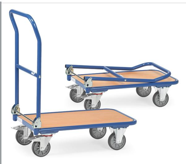
Klappwagen aus Stahlrohr, pulverbeschichtet brilliantblau RAL 5007. Ladefläche aus Holzwerkstoffplatte, Oberfläche Buchendekor. Schiebebügel auf Plattform klappbar. 2 Lenk- und 2 Bockrollen, TPE-Bereifung (spurlos), Nabenhügel mit Rillenkugellager. Feststeller an den Lenkkästen, gemäß der Europäischen Norm EN 1757-3 (Sicherheit von Plattformwagen).
