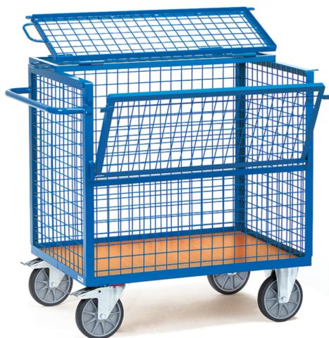
Stahlrohr und Profilstahl geschweißt, pulverbeschichtet blau RAL 5007. Boden aus Holzwerkstoffplatte, Oberfläche Buchendekor. Winkelstahl-Konstruktion. Drahtgitter 50 x 50 x 4 mm eingeschweißt. Deckel aus Drahtgitter, 2-fach klappbar. Ringösen für Vorhängeschlösser. 2 Lenk- und 2 Bockrollen, TPE-Bereifung, Nabens mit Rillenkugellager. Feststeller an den Lenkrollen, gemäß der Europäischen Norm EN 1757-3 (Sicherheit von Plattformwagen). Zerlegte Anlieferung. Nutzhöhe: 806 mm.
