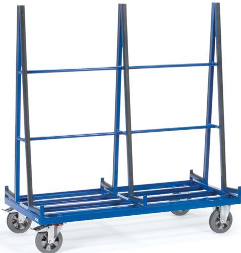
Baukasten-System: zum sicheren Transport von Glasscheiben, Holz- und Kunststoffplatten sowie kompletter Fenster und Türen. Profilstahl und Stahlrohr geschweißt. Pulverbeschichtet, blau RAL 5007. Zweiseitige Anlagen mit Profilgummi belegt. Auflagebreite 2 x 230 mm, Anlagehöhe 1450 mm. 2 Lenk- und 2 Bockrollen, Vollgummi-Elastic-Bereifung, blaugrau "spurlos", Naben mit Kugellager. Feststeller an den Lenkrollen, gemäß der Europäischen Norm EN 1757-3 (Sicherheit von Plattformwagen).
