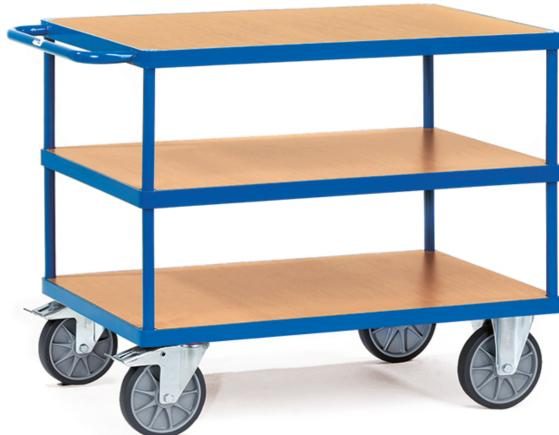
Stahlrohr und Profilstahl geschweißt, pulverbeschichtet RAL 5007. 3 Plattformen aus Holzwerkstoffplatte, Oberfläche Buchendekor. 2 Lenk- und 2 Bockrollen, TPE-Bereifung, Nabens mit Rillenkugellager. Feststeller an den Lenkrollen, gemäß der Europäischen Norm EN 1757-3 (Sicherheit von Plattformwagen). Tragkraft obere und mittlere Ladefläche 200 kg.
