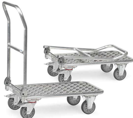
Alurohrwagen mit Aluplatzform, Schiebebügel auf Platzform klappbar. 2 Lenk- und 2 Bockrollen, TPE-Bereifung, Nabens mit Rillenkugellager. Feststeller an den Lenkrollen, gemäß der Europäischen Norm EN 1757-3 (Sicherheit von Plattformwagen).
