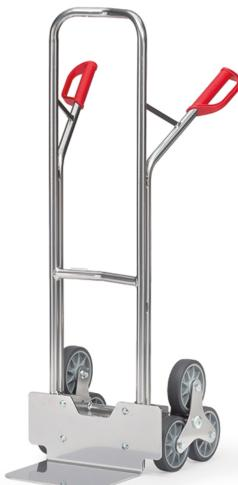
Aus Aluminiumrohr mit Aluminiumschaufel, handliche Schweißkonstruktion. Sicherheitsgriffe. Mit 2 dreiarmigen Rad-Sternen, jeweils 3 TPE-Räder 160 mm Ø, Nabenhügel oben und Querstreben durchgebogen. Für den sicheren Transport von runden Gütern, wie Rollen, Kannen, Eimern usw.
