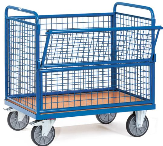
Stahlrohr und Profilstahl geschweißt, pulverbeschichtet blau RAL 5007. Boden aus Holzwerkstoffplatte, Oberfläche Buchendekor. Verschraubte Baukasten-Ausführung: Mit Stahlrohr-Aufbau, Drahtgitter 50 x 50 x 4 mm eingeschweißt 2 Lenk- und 2 Bockrollen, TPE-Bereifung, Nabenhügel mit Rillenkugellager. Feststeller an den Lenkkörpern, gemäß der Europäischen Norm EN 1757-3 (Sicherheit von Plattformwagen). Zerlegte Anlieferung. Nutzhöhe: 700 mm.
