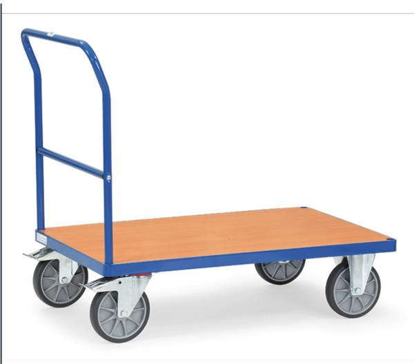
Schiebebügelwagen aus Stahlrohr und Profilstahl geschweißt, pulverbeschichtet brilliantblau RAL 5007. Plattform mit Holzwerkstoffplatte, Oberfläche Buchendekor. 2 Lenk- und 2 Bockrollen, TPE-Bereifung, Nabenhügel mit Rillenkugellager. Feststeller an den Lenkrollen, gemäß der Europäischen Norm EN 1757-3 (Sicherheit von Plattformwagen).
