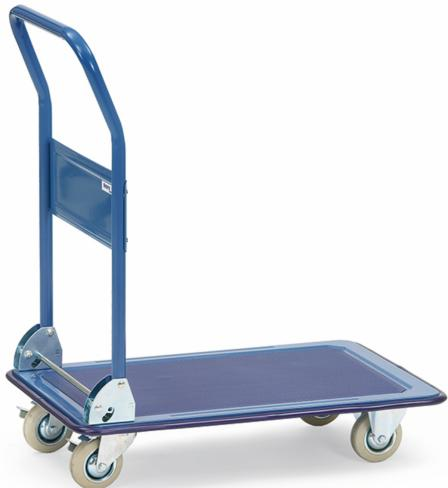
Ganzstahlwagen mit Plattform aus Stahlblech gepresst, pulverbeschichtet blau RAL 5007. Mit aufgeklebtem Antirutschbelag und umlaufender Schutzleiste. Rohrschiebebügel klappbar, mit breiter Querstrebe. Klappgelenk glanzverzinkt. 2 Lenk- und 2 Bockrollen, Vollgummibereifung, Feststeller an den Lenkrollen, gemäß der Europäischen Norm EN 1757-3. Zerlegte Anlieferung.
