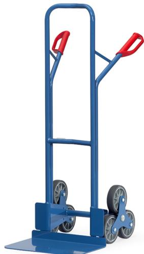
Stabile Schweißkonstruktion, mit Stahlblechschaufel, pulverbeschichtet, nur blau RAL 5007. Sicherheitsgriffe. Zerlegte Anlieferung. Mit 2 dreiarmigen Rad-Sternen, jeweils 3 TPE-Räder 160 mm Ø, Nabenhügel mit Kugellager. Bügel oben und Querstreben durchgebogen. Für den sicheren Transport von runden Gütern, wie Rollen, Kannen, Eimern usw.
