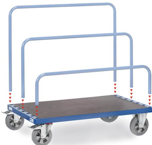
Profilstahl und Stahlrohr geschweißt, pulverbeschichtet, Holzplattform. 7 Verstellmöglichkeiten für Einstiegbügel. Bügelabstand licht 90 mm, 2 Lenk- und 2 Bockrollen, Lenkrollen mit Feststeller gemäß der Europäischen Norm EN 1757-3 (Sicherheit von Plattformwagen). Vollgummi-Elastic-Bereifung, blaugrau "spurlos", Nabenhügel mit Kugellager. Lieferung ohne Bügel.
