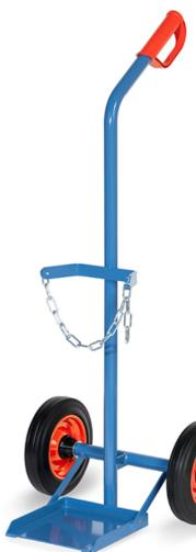
Stahlflaschenkarre aus Stahlrohr geschweißt, pulverbeschichtet blau RAL 5007. Flaschenhalterungen mit Kettensicherung. Räder mit Vollgummibereifung, Nabenhügel mit Rollenlager.
