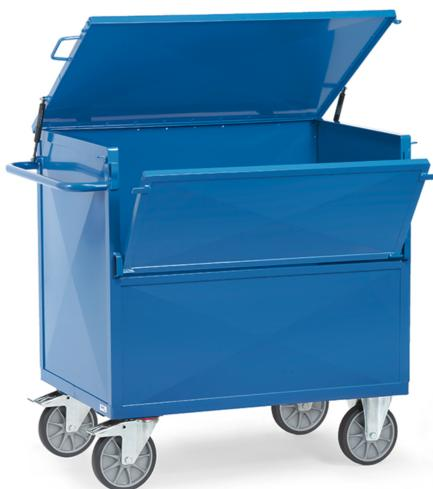
Stahlrohr und Profilstahl geschweißt, pulverbeschichtet blau RAL 5007. Boden aus Stahlblech, pulverbeschichtet. Winkelstahl-Konstruktion. Wände aus gesicktem Stahlblech, eingeschweißt, pulverbeschichtet. 2 Lenk- und 2 Bockrollen, TPE-Bereifung, Nabenhügel mit Rillenkugellager. Feststeller an den Lenkkästen, gemäß der Europäischen Norm EN 1757-3 (Sicherheit von Plattformwagen). Zerlegte Anlieferung. Nutzhöhe: 816 mm.
