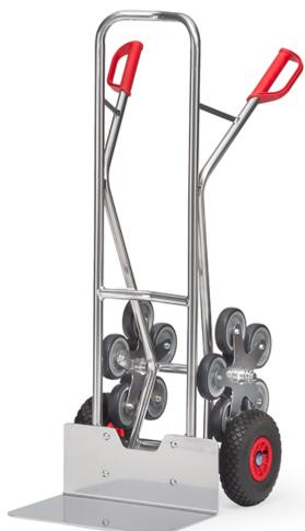
Aus Aluminiumrohr mit Aluminiumschaufel, handliche Schweißkonstruktion. Sicherheitsgriffe. Mit 2 Lufträdern, Kunststoff-Felgen, Nabensicherung und 2 fünfarmigen Radsternen, jeweils 5 TPE-Räder 125 mm Ø, Nabensicherung. Bügel oben und Querstreben durchgebogen. Für den sicheren Transport von runden Gütern, wie Rollen, Kannen, Eimern usw.
