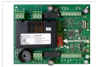
Abb. 9: DIP-Schalter auf der Platine
