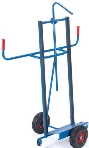
Stahlrohr-Konstruktion mit Stahlblechschaufel, Anlagen mit Profilgummi belegt (rutschsicher), und einstellbarem Niederhalter als Kippsicherung. Pulverbeschichtet blau RAL 5007. Räder mit Vollgummibereifung. Nabenhügel mit Rollenlager. 2 Stützrollen 50 mm Ø. Zerlegte Anlieferung. Zum Längstransport von großflächigen Holz- und Kunststoffplatten.
