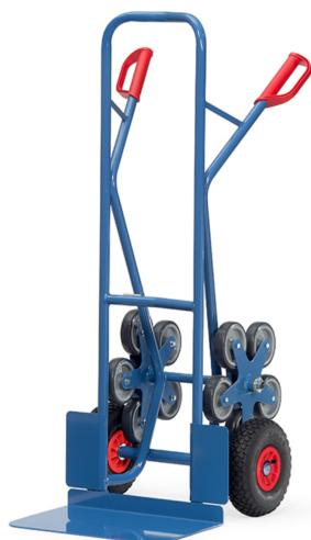
Stabile Schweißkonstruktion, mit Stahlblechschaufel, pulverbeschichtet, nur blau RAL 5007. Sicherheitsgriffe. Zerlegte Anlieferung. Mit 2 Lufträdern, Kunststoff-Felgen, Nabens mit Rollenlagerung und 2 fünfarmigen Rad-Sternen, jeweils 5 TPE-Räder 125 mm Ø, Nabens mit Gleitlager. Bügel oben und Querstreben durchgebogen. Für den sicheren Transport von runden Gütern, wie Rollen, Kannen, Eimern usw.
