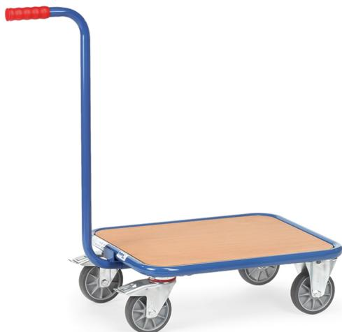
Griffroller aus Stahlrohr geschweißt, pulverbeschichtet brilliantblau RAL 5007. Mit Holzplattform, Plattform mit im Rahmen liegender Holzwerkstoffplatte, Oberfläche Buchendekor. Griff anschraubbar. 2 Lenk- und 2 Bockrollen, TPE-Bereifung (spurlos), Nabenhügel mit Rillenkugellager, Feststeller an den Lenkrollen, gemäß der Europäischen Norm EN 1757-3 (Sicherheit von Plattformwagen).
