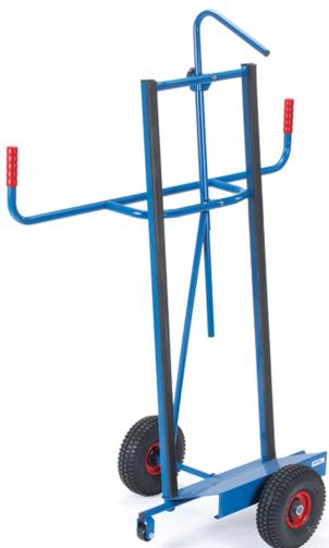
Stahlrohr-Konstruktion mit Stahlblechschaufel, Anlagen mit Profilgummi belegt (rutschsicher), und einstellbarem Niederhalter als Kippsicherung. Pulverbeschichtet blau RAL 5007. Räder mit Luftbereifung. Nabens mit Rollenlager. 2 Stützrollen 50 mm Ø. Zerlegte Anlieferung. Zum Längstransport von großflächigen Holz- und Kunststoffplatten.
