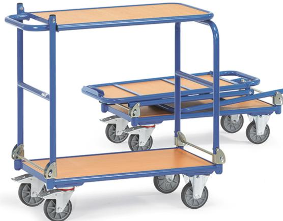
Stahlrohr-Tischwagen, pulverbeschichtet brillantblau RAL 5007, Ladefläche aus Holzwerkstoffplatte, Oberfläche Buchendekor. Mit 2 klappbaren Bügeln und mit klappbarer Tischplattform. 2 Lenk- und 2 Bockrollen, TPE-Bereifung, Nabenhügel mit Rillenkugellager. Feststeller an den Lenkrollen, gemäß der Europäischen Norm EN 1757-3 (Sicherheit von Plattformwagen). Tragkraft obere Ladefläche 80 kg. Deutsches Patent 100 62 425.
