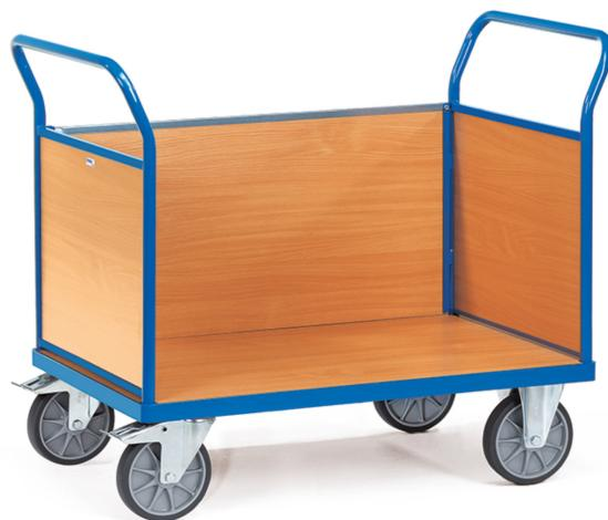
Stahlrohr und Profilstahl geschweißt, pulverbeschichtet RAL 5007, Plattform Holzwerkstoffplatte, Oberfläche Buchendekor. 2 Stirnwände und 1 Längswand aus Holzwerkstoffplatte, Oberfläche Buchendekor, Wände 500 mm hoch. 2 Lenk- und 2 Bockrollen, TPE-Bereifung, Nabenhügel mit Rillenkugellager. Feststeller an den Lenkrollen, gemäß der Europäischen Norm EN 1757-3 (Sicherheit von Plattformwagen).
