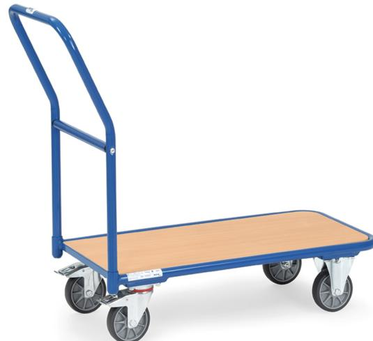
Stahlrohr, Schweißkonstruktion, pulverbeschichtet, blau RAL 5007. Plattform Holzwerkstoffplatte, Oberfläche Buchendekor. 2 Lenk- und 2 Bockrollen, TPE-Bereifung, Nabens mit Rillenkugellager. Feststeller an den Lenkrollen, gemäß der Europäischen Norm EN 1757-3 (Sicherheit von Plattformwagen).
