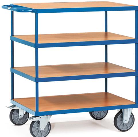
Stahlrohr und Profilstahl geschweißt, pulverbeschichtet RAL 5007. 4 Plattformen aus Holzwerkstoffplatte, Oberfläche Buchendekor. 2 Lenk- und 2 Bockrollen, TPE-Bereifung, Nabens mit Rillenkugellager. Feststeller an den Lenkrollen, gemäß der Europäischen Norm EN 1757-3 (Sicherheit von Plattformwagen).
