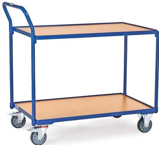
Leichter Tischwagen im Baukasten-System. Stahlrohr und Profilstahl geschweißt, pulverbeschichtet. Schraubkonstruktion. 2 Böden aus Holzwerkstoffplatte, Oberfläche Buchendekor, im Stahlrahmen liegend, Rand 12 mm hoch. Schiebegriff hochstehend. 2 Lenk- und 2 Bockrollen, TPE-Bereifung, Nabensicherung mit Rillenkugellager. Feststeller an den Lenkrollen, gemäß der Europäischen Norm EN 1757-3 (Sicherheit von Plattformwagen). Tragkraft obere Ladefläche 80 kg.
