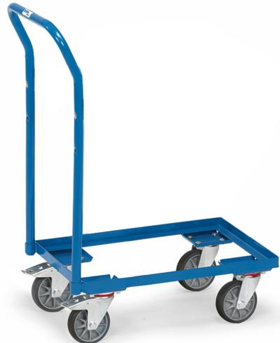
Offene Winkelstahlkonstruktion mit Rohrschiebebügel, pulverbeschichtet blau RAL 5007. 4 Lenkkästen mit TPE-Bereifung, Nabensicherung mit Rillenkugellager. 2 Stück mit Feststeller, gemäß der Europäischen Norm EN 1757-3 (Sicherheit von Plattformwagen). Passend für Eurokästen 600 x 400 mm.
