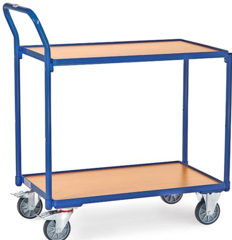
Leichter Tischwagen im Baukasten-System. Stahlrohr und Profilstahl geschweißt, pulverbeschichtet. Schraubkonstruktion. 2 Böden aus Holzwerkstoffplatte, Oberfläche Buchendekor, im Stahlrahmen liegend, Rand 12 mm hoch. Schiebegriff hochstehend. 2 Lenk- und 2 Bockrollen, TPE-Bereifung, Nabensicherung mit Rillenkugellager. Feststeller an den Lenkrollen, gemäß der Europäischen Norm EN 1757-3 (Sicherheit von Plattformwagen). Tragkraft obere Ladefläche 80 kg.
