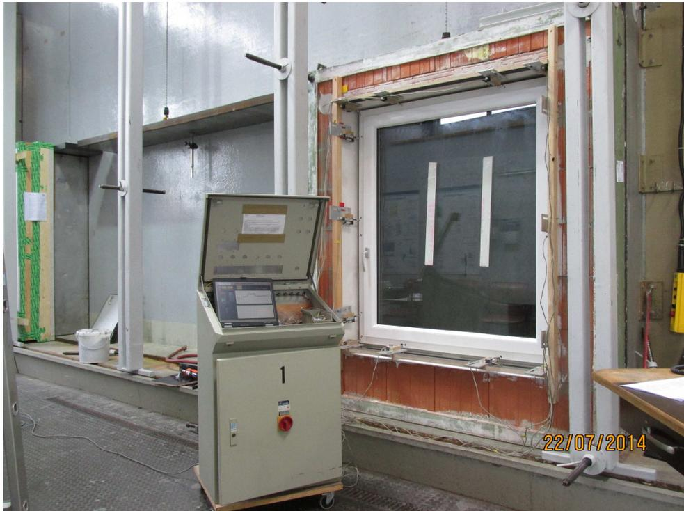
**Bild 9** Ansicht Probekörper mit angebrachten Messstellen
