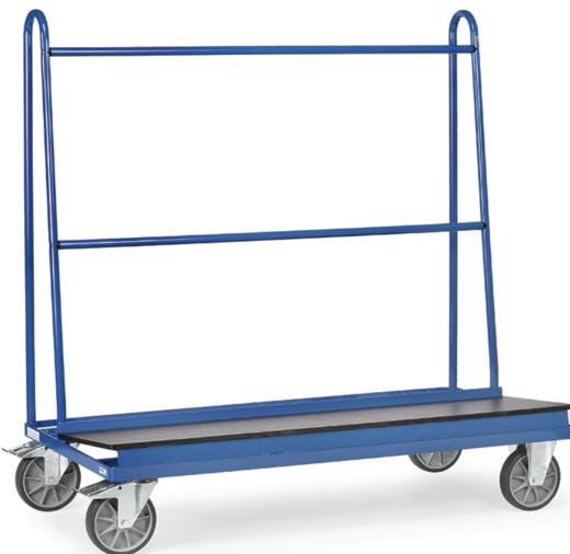
Profilstahl und Stahlrohr geschweißt, Ladefläche aus rutschsicherer Siebdruckplatte aus wasserfestem Sperrholz. 2 Lenk- und 2 Bockrollen, TPE-Bereifung, Nabenhügel mit Rillenkugellager. Feststeller an den Lenkketten, gemäß der Europäischen Norm EN 1757-3 (Sicherheit von Plattformwagen). Anlagehöhe 1150 mm.
