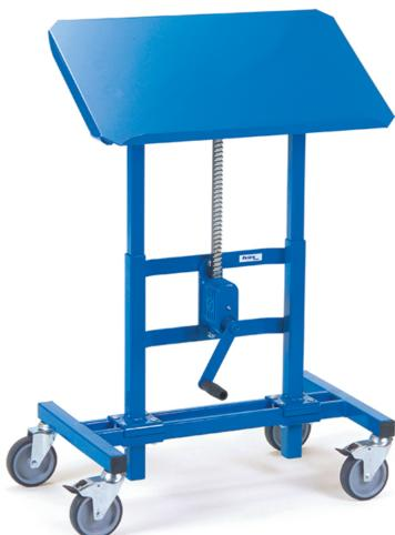
Für Kunststoffkästen, Stahlblechkästen, Drahtkörbe usw., höhenverstellbar und fahrbar. Profilstahl-/Rohrkonstruktion mit Stahlblechplattform. Plattform mit einseitiger Anlagekante, neigbar um 15° und 30°, stufenlos höhenverstellbar mittels Zahnstangenwinde, auch unter Last möglich. 2 Teleskopsäulen. Pulverbeschichtet blau RAL 5007. 4 Lenkrollen, Nabenhügel mit Gleitlagerung, 2 davon mit Feststeller gemäß der Europäischen Norm EN 1757-3 (Sicherheit von Plattformwagen).
