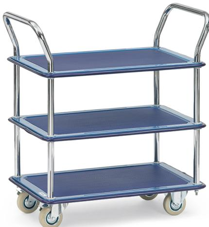
Tischwagen mit 3 Plattformen aus Stahlblech gepresst, pulverbeschichtet brilliantblau RAL 5007. Mit aufgeklebtem Antirutschbelag und umlaufender Schutzleiste. Rohrschiebebügel feststehend, glanzverzinkt. 2 Lenk- und 2 Bockrollen, Vollgummi-Bereifung, Feststeller an den Lenkketten, gemäß der Europäischen Norm EN 1757-3. Zerlegte Anlieferung. Tragkraft obere und mittlere Ladefläche 60 kg.
