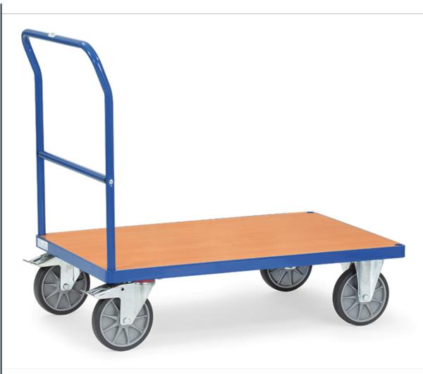
Schiebebügelwagen aus Stahlrohr und Profilstahl geschweißt, pulverbeschichtet brilliantblau RAL 5007. Plattform mit Holzwerkstoffplatte, Oberfläche Buchendekor. 2 Lenk- und 2 Bockrollen, TPE-Bereifung, Nabenhügel mit Rillenkugellager. Feststeller an den Lenkrollen, gemäß der Europäischen Norm EN 1757-3 (Sicherheit von Plattformwagen).
