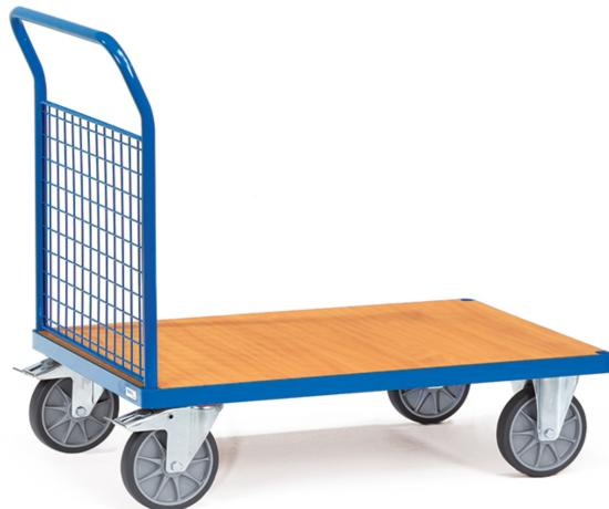
Stahlrohr und Profilstahl geschweißt, pulverbeschichtet RAL 5007, Plattform Holzwerkstoffplatte, Oberfläche Buchendekor. Stirnwand aus Drahtgitter 50 x 50 x 4 mm, Wand 500 mm hoch. 2 Lenk- und 2 Bockrollen, TPE-Bereifung, Nabensicherung mit Rillenkugellager. Feststeller an den Lenkketten, gemäß der Europäischen Norm EN 1757-3 (Sicherheit von Plattformwagen).
