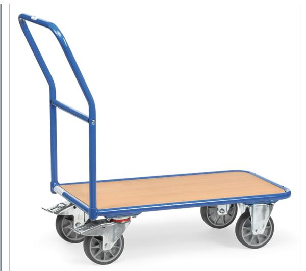
Stahlrohr, Schweißkonstruktion, pulverbeschichtet, brillantblau RAL 5007. Plattform Holzwerkstoffplatte, Oberfläche Buchendekor. 2 Lenk- und 2 Bockrollen, TPE-Bereifung, Nabensicherung mit Rillenkugellager. Feststeller an den Lenkkörpern, gemäß der Europäischen Norm EN 1757-3 (Sicherheit von Plattformwagen).
